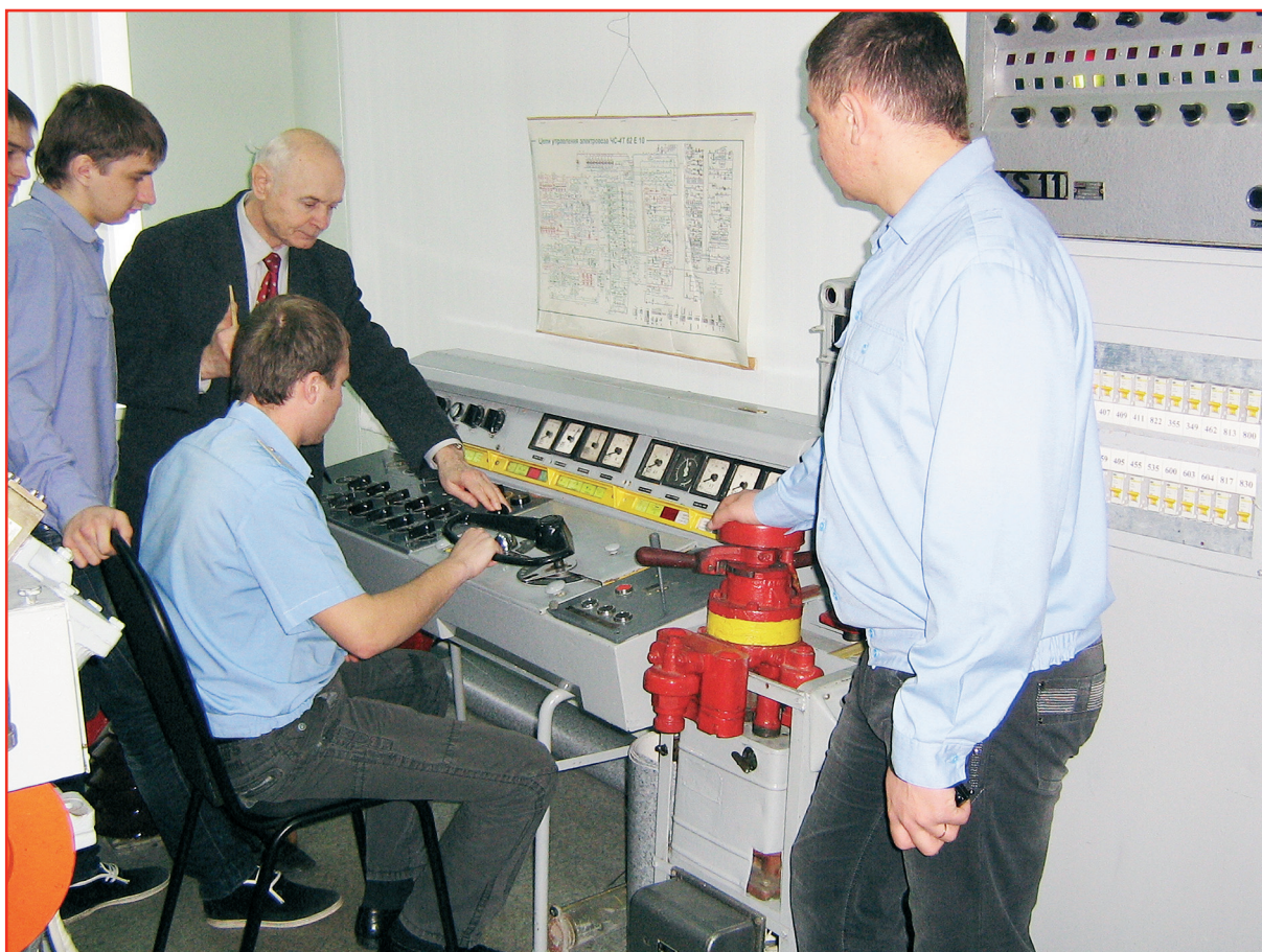
Рисунок 4. Проверка работы электрической схемы электровоза ЧС4Т.
