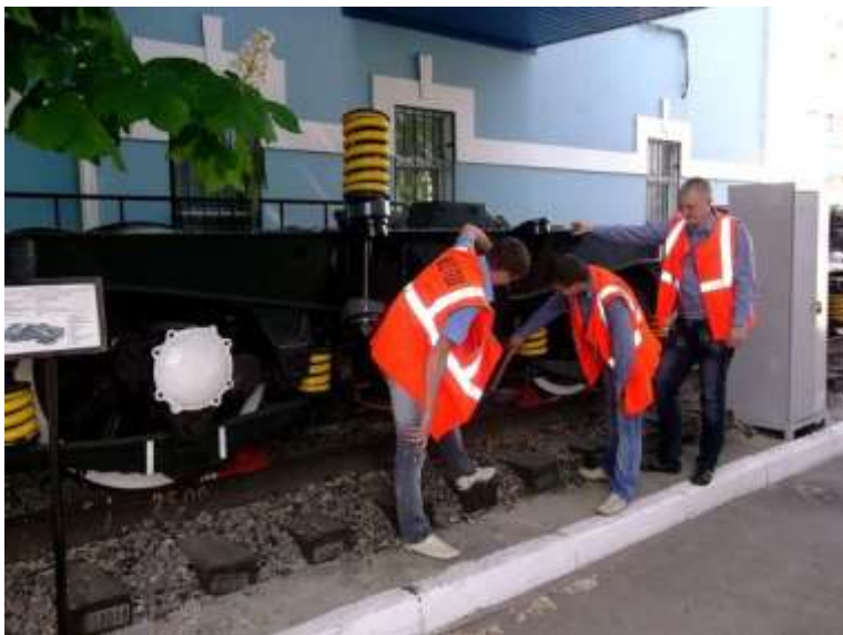
1-ый этап - осмотр ТРП и выявление неисправностей
