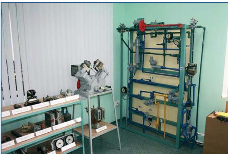
Пневмопанель и система блокирования дали возможность пневматически и электрически подключить токоприемник через электрический пульт управления, что позволило решить несколько задач:
