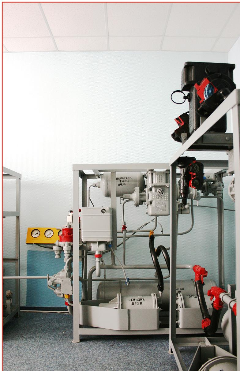
На трубопроводе от тормозной магистрали к воздухораспределителю № 483 установлен разобщительный кран. На пульте машиниста расположены три манометра:
